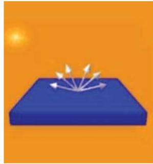
**Riflessione diffusa:** il flusso incidente lungo una direzione viene rinvio con intensità uniforme in tutte le direzioni. Non è riconoscibile alcuna immagine riflessa. E' il comportamento di superfici rugose e matte come l'intonaco a stucco usuale, tappeti, etc.
