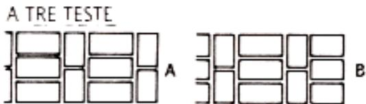
Una variante della disposizione gotica è caratterizzata da un addensamento in verticale delle presenze degli elementi apparenti di testa e degli elementi apparenti di lista che si presentano sfalsati, da un filare a quello superiore, di mezza testa.
