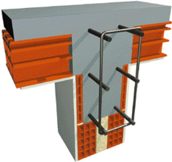
*Rivestimento di una trave non contenuta nello spessore del solaio con tavole di laterizio al fine di realizzare un supporto omogeneo sotto l'intonaco.*
