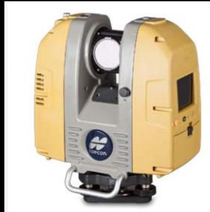
Il risultato del rilevamento è un insieme di punti dell'oggetto (chiamato nuvola di punti) dall'elaborazione del quale è possibile ricavare prospetti, piante, sezioni e ricostruire un modello digitale tridimensionale dell'oggetto scansionato
