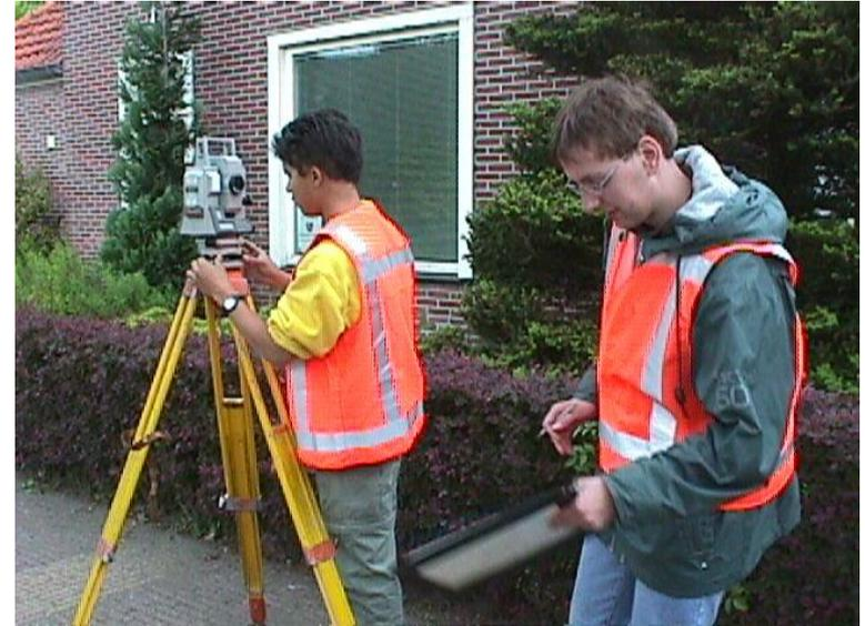
Durante le operazioni di rilievo si eseguono misure di **angoli, distanze e dislivelli** con le quali è possibile determinare le **coordinate** di punti appartenenti ad oggetti.
