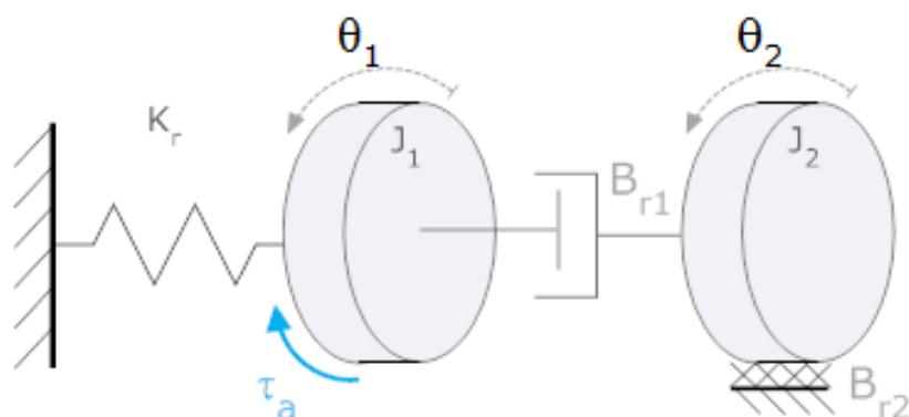
Dall'analisi di bilancio delle forze generalizzate applicate ai due cilindri, si ottengono le seguenti equazioni differenziali:
