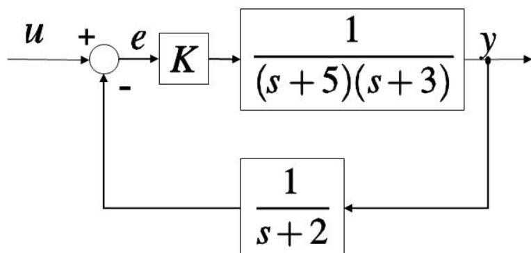
si calcoli il valore di  $K$  con il quale l'errore a regime (i.e. il segnale  $e(t)$  per  $t$  che tende all'infinito) in risposta ad un gradino di ampiezza unitaria ( $U(s) = 1 / s$ ) risulta:
