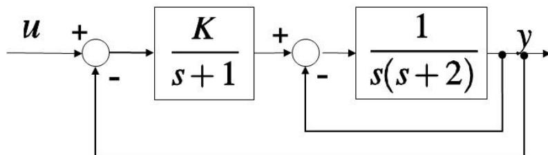
determinare l'intervallo dei valori di  $K$  per i quali il sistema complessivo risulti asintoticamente stabile
