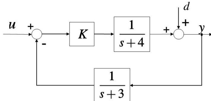
si determini il valore di  $K$  tale per cui  $y(t) \rightarrow 0,1$  per  $t \rightarrow \infty$ , imponendo  $u(t) = 0$  ed applicando un gradino unitario al segnale  $d(t)$  (cioè:  $D(s) = 1 / s$ ).
