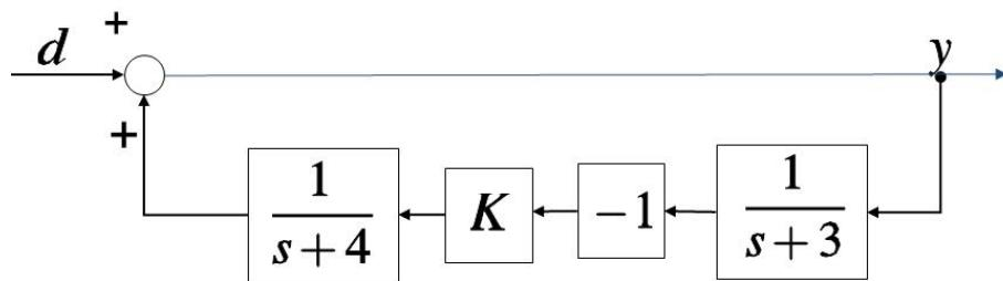
Si noti che il nodo sommatore a sinistra nel diagramma iniziale è stato sostituito con il blocco  $-1$  nel ramo di retroazione, perciò di fatto si tratta ancora di un anello con retroazione negativa. Risolvendo l'anello per ottenere la funzione di trasferimento  $G_{cl}(s)$ , applicando il teorema del valore finale al segnale  $Y(s) = G_{cl}(s) D(s)$  ed imponendo il vincolo fornito dal testo si ottiene:
