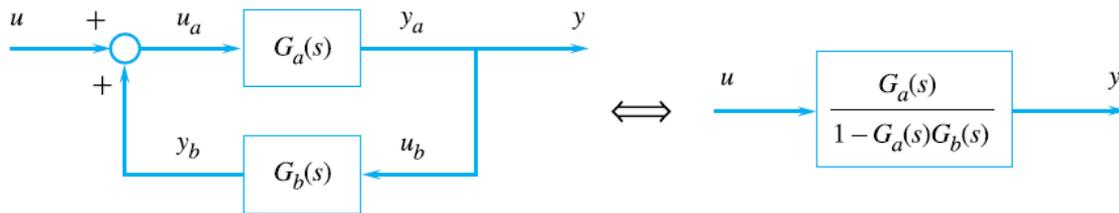
**N.B.:** applicando le 9 regole viste, uno schema con un ingresso e una uscita si riduce ad un solo blocco:
