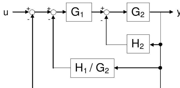
che contiene **DUE** anelli (il blocco  $H_1 / G_2$  è in parallelo con un ramo a guadagno unitario):
