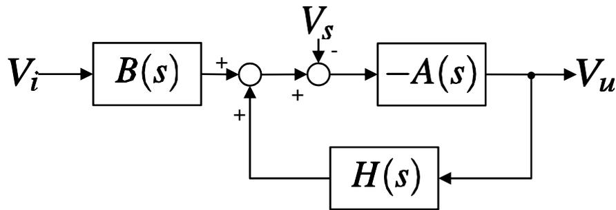
Con  $V_s$  = tensione di *offset* dell'amplificatore
