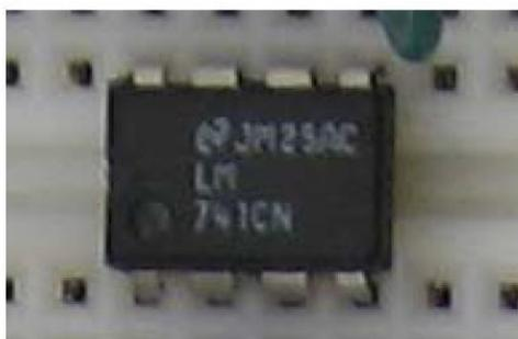
*Figura2*: Amplificatore Operazionale LM741.
