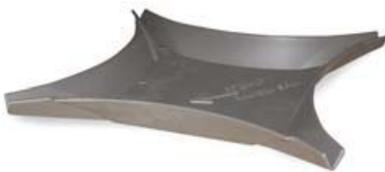
Beton Up è un accessorio del sistema Iglu® (o Atlantis) che impedisce al calcestruzzo di formare pilastri. In questo modo i casseri assumono la funzione di un semplice impalcato sul quale può essere realizzata una soletta monolitica in calcestruzzo armato vincolata al contorno. Con Beton Up il solaio non è autoportante.
