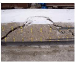
La rottura si manifesta con il distacco di un tronco di cono di cls dalla piastra, tipicamente inclinata di un angolo  $\theta$ =26.6°
