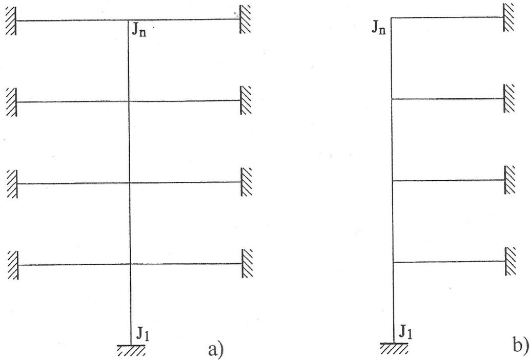
Fig. 9.28 – Modelli ridotti ricorrenti per il calcolo dei pilastri interni e dei pilastri di bordo di telai regolari
