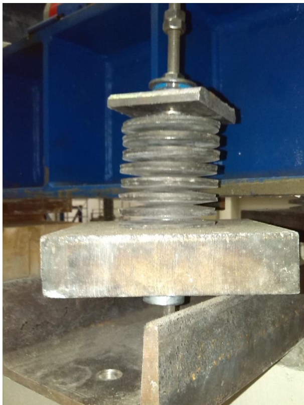
Figura 2.12 - Colonna di molle a tazza del sistema di precompressione
