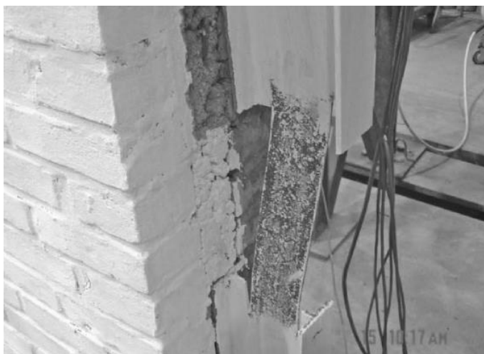
Figura 1.17 - Dettaglio del secondo provino con riduzione locale della sezione resistente dei pilastri (Mohammadi, et al., 2011)
