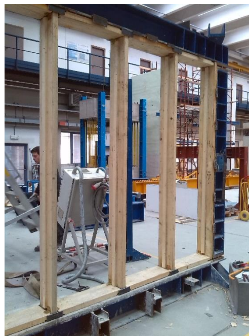
Figura 2.23 - Modello di comportamento dei listelli verticali (a sinistra) e loro realizzazione (a destra)
