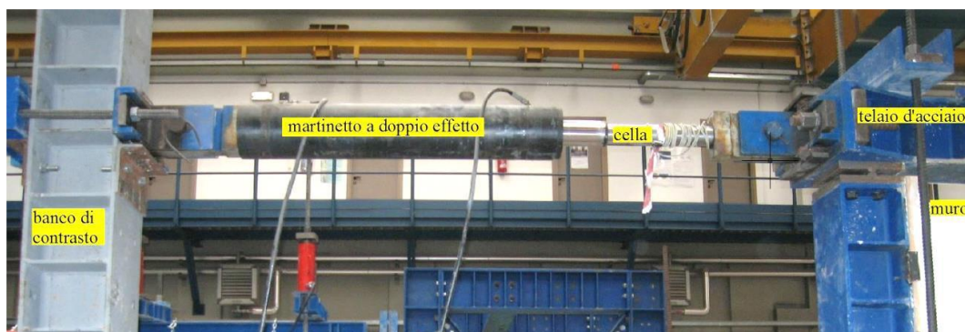
Figura 5.1 - Dettaglio di montaggio del martinetto idraulico
