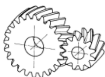
Ruote cilindriche a denti elicoidali (ingranaggio esterno). Trasmissione del moto tra assi paralleli .
