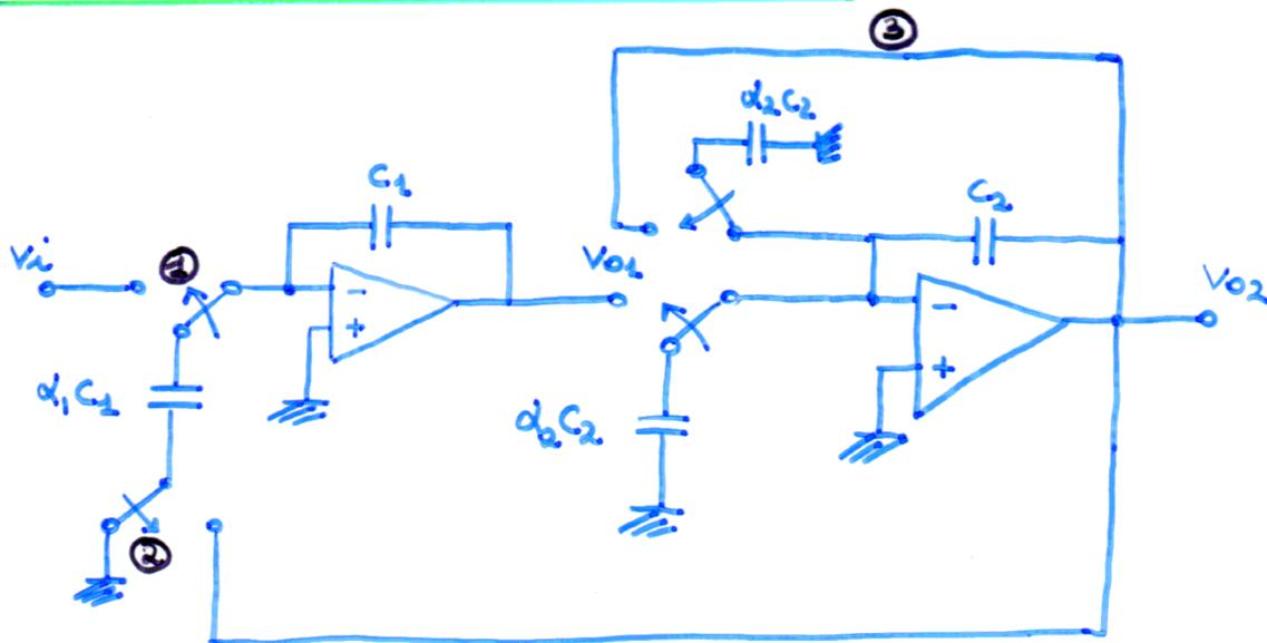
N.B. La differenza tra i segnali  $V_{o2}$  e  $V_i$  in ingresso viene effettuata PILOTANDO gli interruttori IN CONTROFASE (1 e 2)
